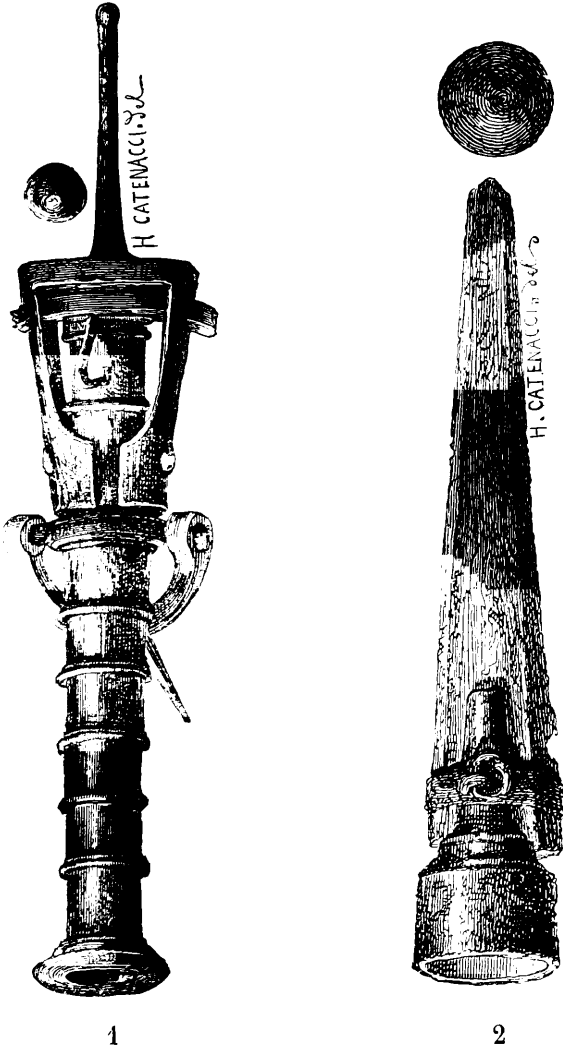
Fig. 56. — 1, Canon à boîte du quatorzième siècle. 2, Canon d'une seule pièce.
